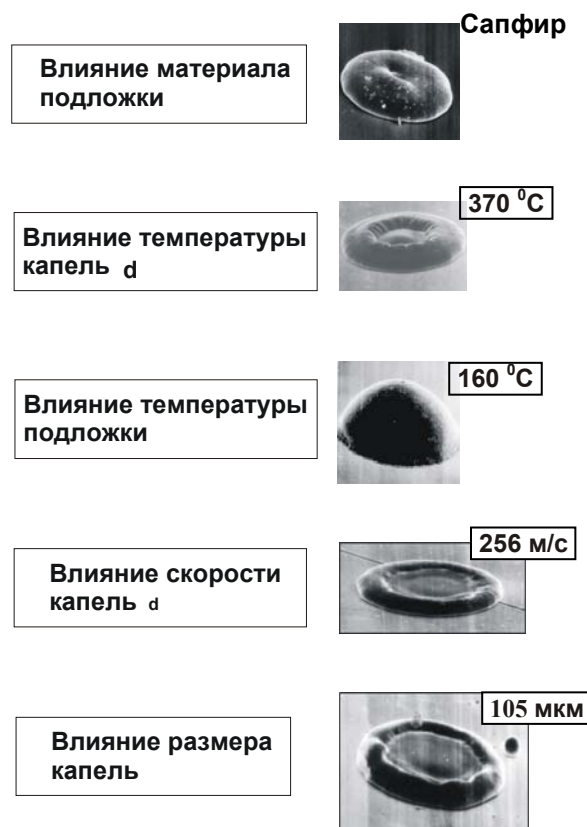
Рис. 2. Взаимодействие микрокапель металла с поверхностью
