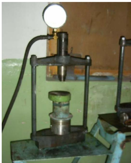
Рис.1. Гидравлический пресс
