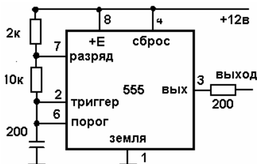
Рис. 6. Вариант реализации генератора на микросхеме таймера 555
