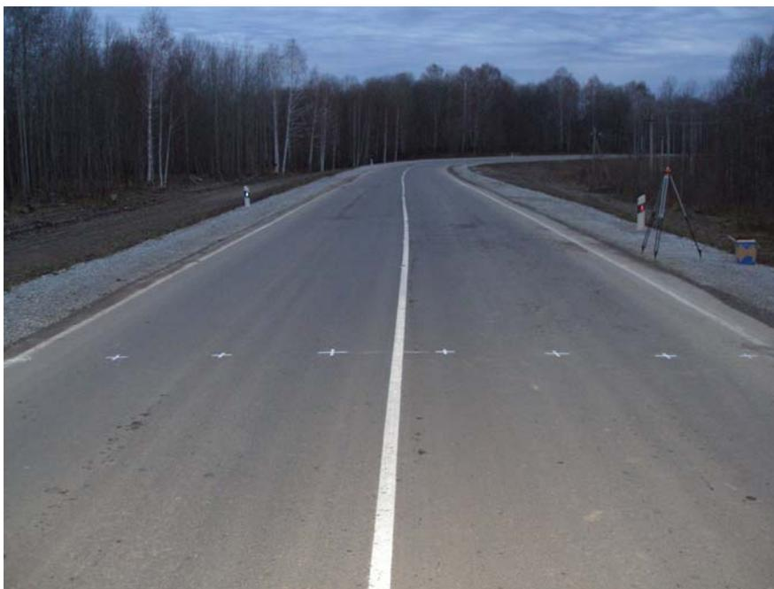
Рис. 2. Установленные поверхностные марки на автодороге «Бийск-Мартыново-Кузедеево»
