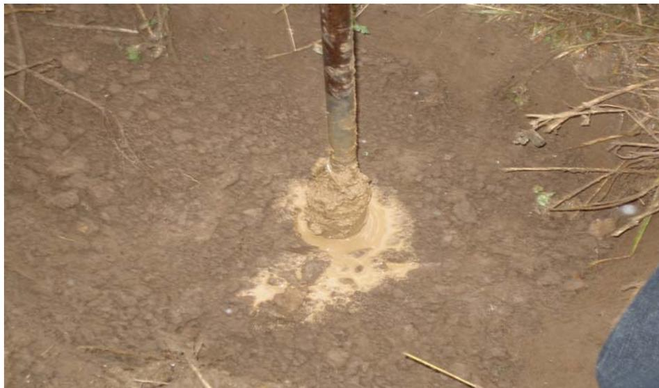
Рис. 1. Пример сильного переувлажнения на расстоянии 30 см, от поверхности на а/д "Бийск-Мартыново-Кузедеево"
