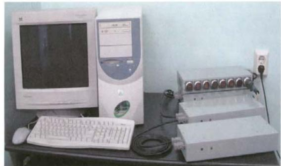
Рис. 12. Микропроцессорная многоканальная тензометрическая система ММТС-64.01
