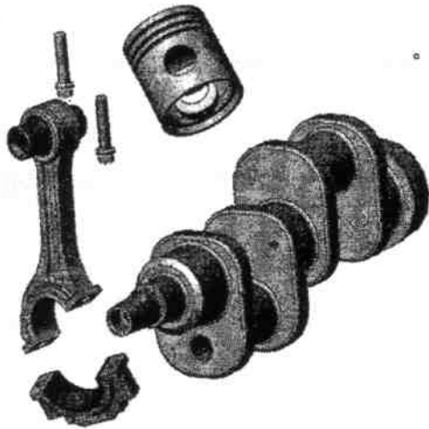
Рис. 4. Компьютерная сборка кривошипно-шатунного механизма
