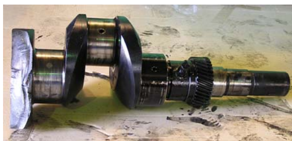
Рис. 1. Усталостный излом коленчатого вала главного двигателя РТ-628, ОАО «Новосибирский речной порт»
