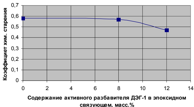
Рис. 4. Зависимость коэффициента химического старения стеклопластикового стержня, выдержанного в среде CaOH в течение 14 часов при температуре 140 0 C, от содержания активного разбавителя ДЭГ – 1 в эпоксидном связующем
