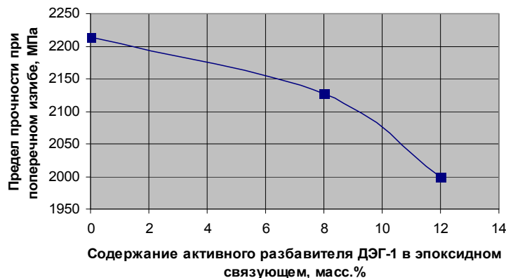
Рис. 2. Зависимость предела прочности при поперечном изгибе стеклопластикового стержня диаметром 5,4 мм от содержания активного разбавителя ДЭГ – 1 в эпоксидном связующем
