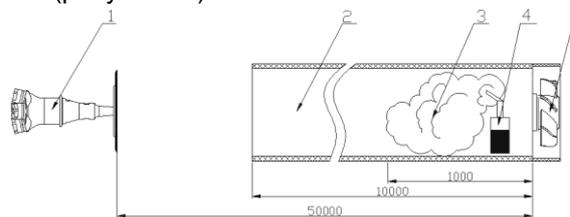
Рис. 14. Схема проведения эксперимента: 1 – дисковый излучатель; 2 – короб; 3 – аэрозоль; 4 – источник аэрозоля; 5 – вентилятор
