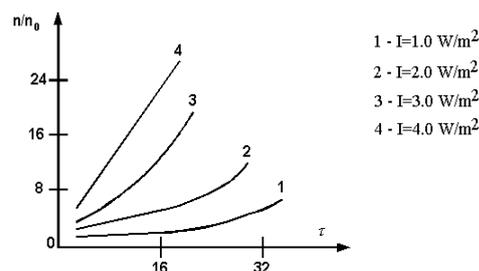
Рис. 2. Зависимость постоянной времени коагуляции от звукового давления
