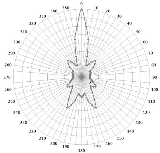
Рис. 11. Диаграмма направленности для дискового излучателя на первой гармонике
