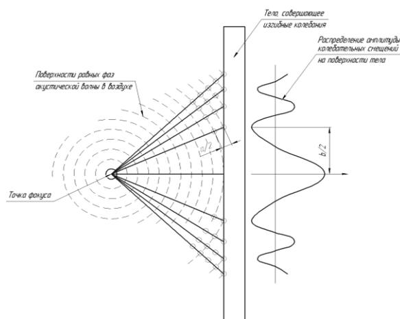
Рис. 5. Схематичное изображение, поясняющее принцип работы фазированного фокусирующего излучателя:  $a$  – длина акустической волны в воздушной среде;  $b$  – волны изгибных колебаний в твердом теле
