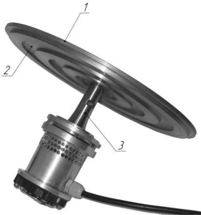
Рис. 6. Фокусирующий пьезоэлектрический излучатель: 1 – диск; 2 – фазовыравнивающие канавки; 3 – колебательная система
