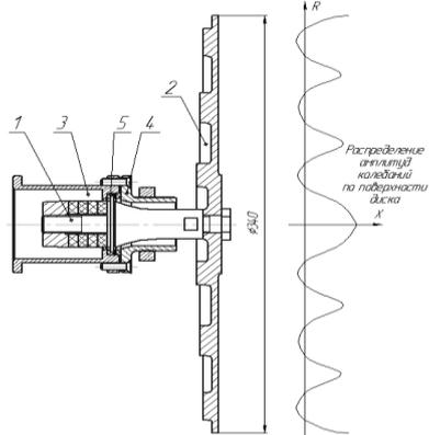
Рис. 8. Диск ступенчато-переменного сечения с преимущественным излучением одной фазы колебаний
