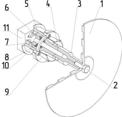
Рис. 10. Конструктивное исполнение излучателя ультразвуковой колебательной системы: 1 – излучающий диск; 2 – болт; 3 – дополнительный концентратор; 4 – основной концентратор; 5 – пьезоэлектрические элементы; 6 – задняя частотопонижающая накладка; 7 – шпилька; 8 – кольцо акустической развязки; 9 – фланец корпуса; 10 – корпус; 11 – вентилятор
