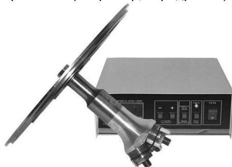
Рис. 18. Ультразвуковое оборудование для осаждения аэрозолей на открытых пространствах
