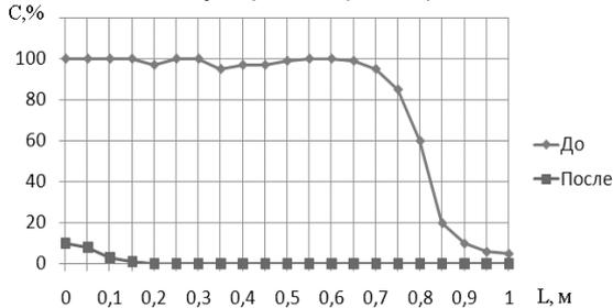
Рис. 15. Распределение концентрации аэрозоля до и после УЗ воздействия
