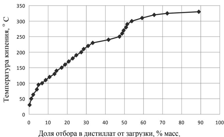
Рисунок 2. Кривая разгонки по методу Энглера образца нефти месторождения «Майское»
