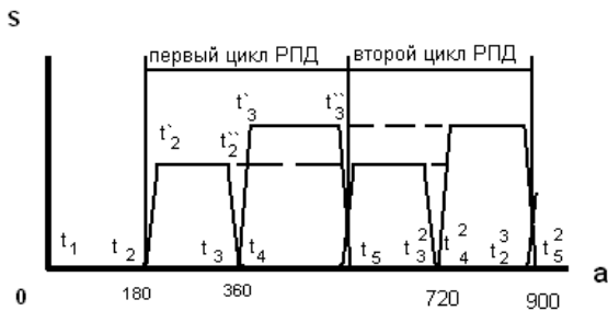
Рисунок 8 – Суммарный график фаз газораспределения: t_1 - t_2 – сжатие рабочей смеси в полости ротора компрессора; t_2 - t_4 – сжатие рабочей смеси в камере сгорания; t_2' – точка открытия впускных окон 2-го цикла (начало повторения циклов); t_3 - t_5 – рабочий ход; t_5 – точка закрытия выпускных окон; t_2' - t_5 – продувка камеры сгорания
