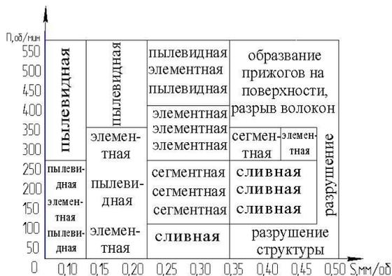
Рисунок 2 – Номограмма для определения вида стружки
