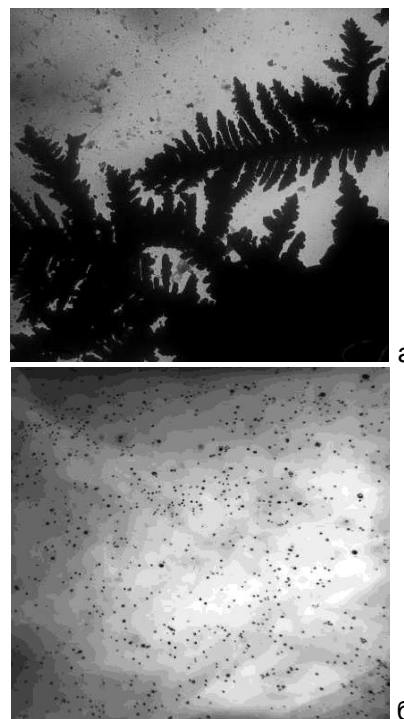
Рисунок 3. Микрофотографии ультрадисперсных частиц Ag: а) n=1, б) n=4
