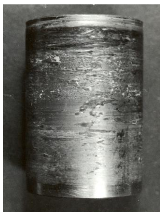
Рисунок 6 - Поверхность стального контртела после 1,5 часов фрикционного взаимодействия с фторопластовой втулкой, содержащей 30% ПТФЭ + 70мас.% Pb (спекание в среде диссоциированного аммиака)
