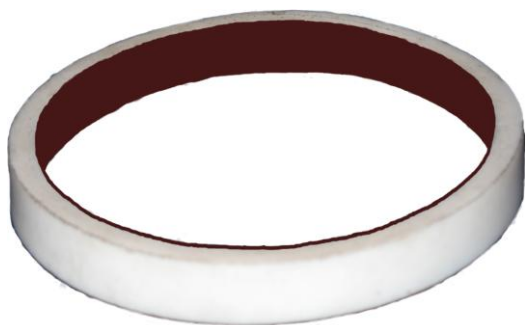
Рисунок 11 - Фторопластовая заготовка с нанесенным по внутренней поверхности полимер-полимерным покрытием с ПБИ
