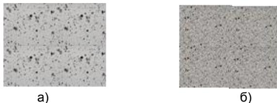
Рисунок 1. Распределение наночастиц оксида железа в эпоксидной смоле с применением: механического устройства (а); механического устройства и ультразвукового диспергатора (б)
