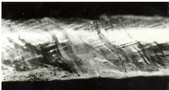
Рисунок 2. Микрофотография поверхности волокна TICl, испытанного на растяжение после предварительного изгиба
