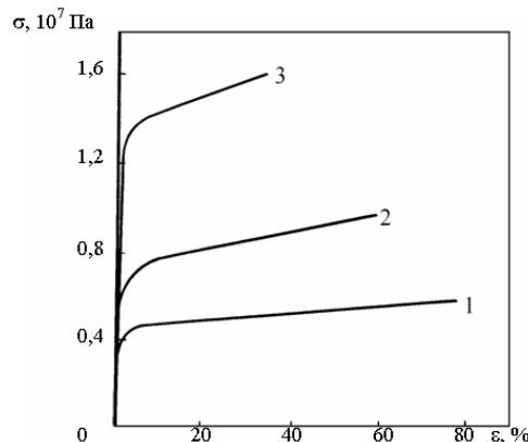
Рисунок 1. Диаграммы растяжения образцов волокон  $\text{TlCl}$  после предварительного изгиба:
