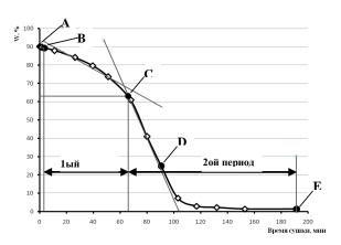
Рисунок 3. Зависимость изменения влажности сброженного остатка избыточного активного ила от времени сушки при t=105°C
