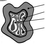
Рисунок 2. Распределение воды в хлопьях сброженного остатка: 1 — свободная вода; 2 — физико-механически связанная вода; 3 — физико-химически связанная вода; 4 — химическая связанная вода
