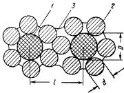
Рисунок 1. Схема образования топливной гранулы с добавкой гидрофильных частиц
