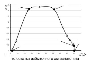
Начальный период сушки характеризуется отрезком АВ, параллельным оси абсцисс - прогревание осадка. Далее интенсивность сушки быстро возрастает и достижения максимальной скорости испарения (участок ВС), она становится постоянной (отрезок CD) до определенного момента. В период от точ-ки А до точки D содержание влаги снижается на максимальную величину (55-60%) за счет удаления влаги с поверхности материала, а также из крупных пор и капилляров, заполненных водой.
