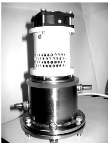
Рисунок 2 – Кавитационный широкополосный акустический излучатель
