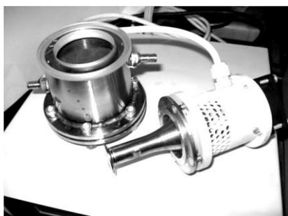
Рисунок 3 – Кавитационный широкополосный акустический излучатель (УЗ вибратор отсоединён)
