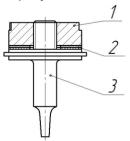
Рисунок 2. Конструкция ультразвуковой колебательной системы для распыления: 1 — пьезоэлектрические элементы; 2 — частотнопонижающая накладка; 3 — концентратор механических колебаний
