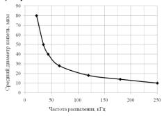
Рисунок 1. Зависимость диаметра формируемых капель от частоты распылителя
