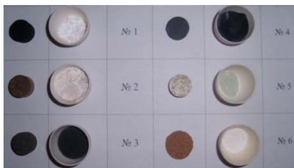
Рисунок 5. Фотография образцов до и после нагрева до температуры 1000 °С
