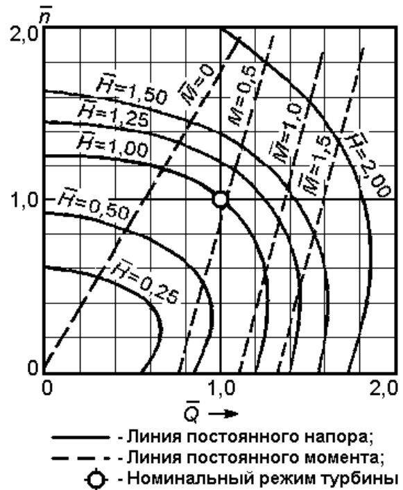
Рисунок 4 – Характеристика турбины в координатах \frac{n}{n_{ном}} = f\left(\frac{Q}{Q_{ном}}\right) при \frac{H}{H_{ном}} = const и
