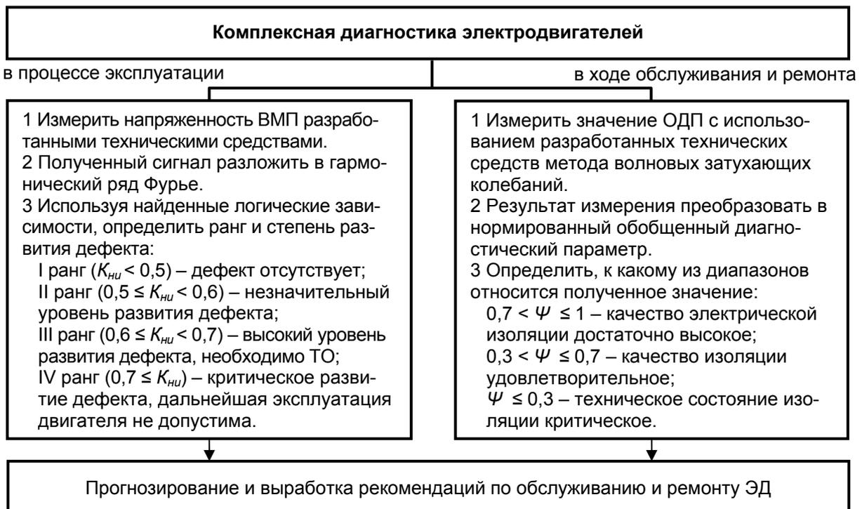
Рисунок 7 – Структура использования разработанных методов диагностики
