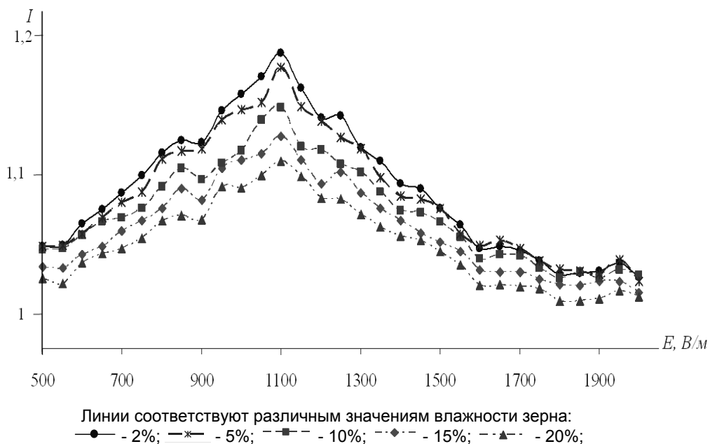
Рисунок 5 – Изменение водопоглощения при различных значениях влажности
