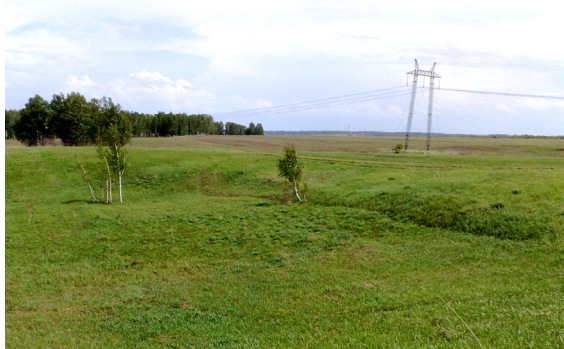
Рисунок 4 – Просадки на северо-западной окраине города Барнаула, замеченные весной 2010 года после таяния снега
