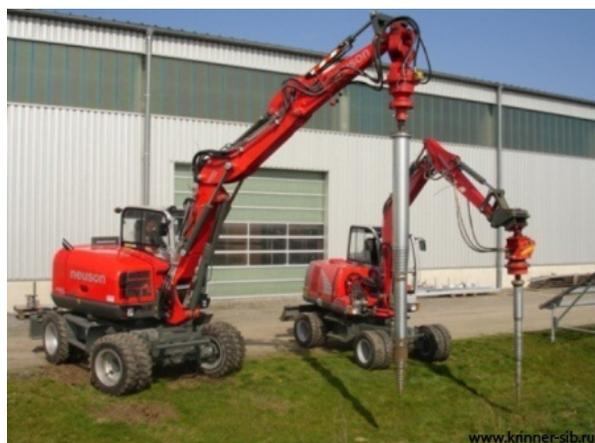
Рисунок 3 – Сваепогружающие механизмы
