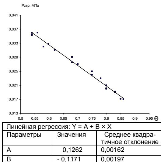
Рисунок 1 – Корреляционная зависимость между структурной прочностью и коэффициентом пористости лессового суглинка при  $J_L < 0$
