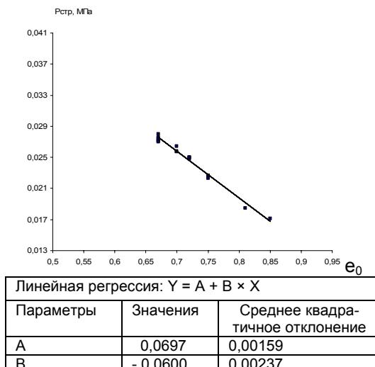
Рисунок 2 – Корреляционная зависимость между структурной прочностью и коэффициентом пористости лессового суглинка при  $J_L$  в пределах от 0 до 0,25
