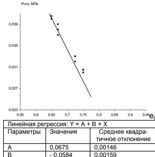
Рисунок 3 – Корреляционная зависимость между структурной прочностью и коэффициентом пористости лессового суглинка при  $J_L$  в пределах от 0,25 до 0,50
