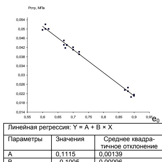
Рисунок 4 – Корреляционная зависимость между структурной прочностью и коэффициентом пористости лессовой супеси при  $J_L < 0$
