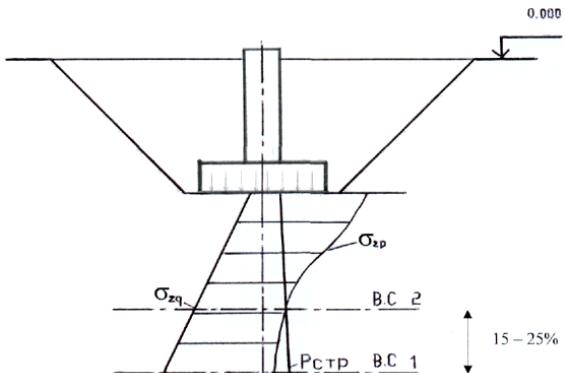
Рисунок 6 – Схема распределения вертикальных напряжений: BC1 – граница сжимаемой толщи грунта основания по СНиП 2.02.01-83\* «Основания зданий и сооружений»; BC2 – граница сжимаемой толщи грунта основания с учетом структурной прочности лессового грунта Рстр
