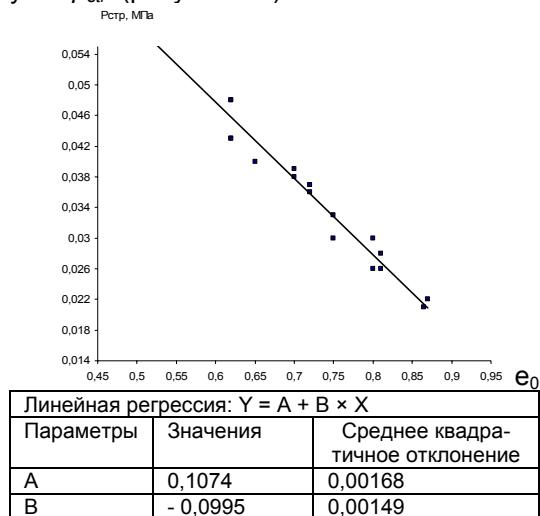
Рисунок 5 – Корреляционная зависимость между структурной прочностью и коэффициентом пористости лессовой супеси при  $J_L$  в пределах от 0 до 1
