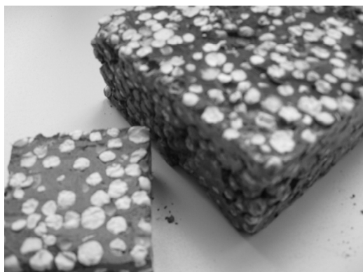
Рисунок 3 – Образцы теплоизоляционных материалов на основе магнезиального вяжущего с отходами целлюлозной промышленности с пенополистирольными гранулами
