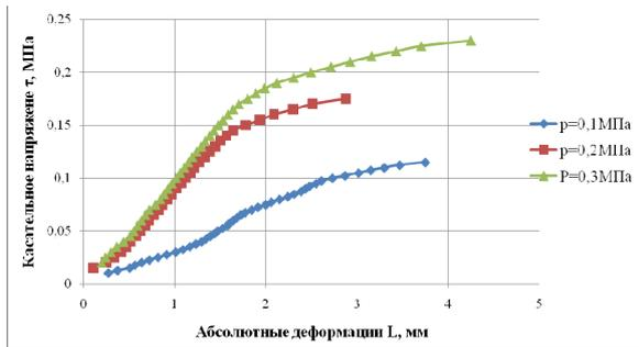
Рисунок 4 – График зависимости деформаций грунта от сдвигающих напряжений ненагруженной зоны площадки № 1
