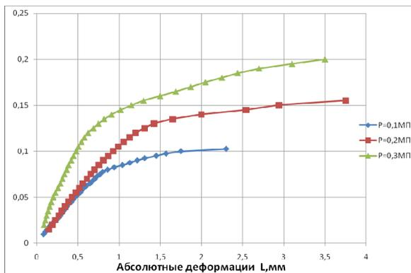
Рисунок 6 – График зависимости деформаций грунта от сдвигающих напряжений нагруженной зоны площадки № 2
