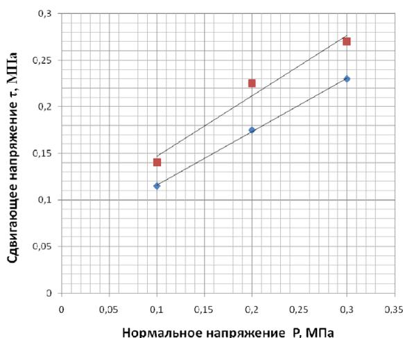
Рисунок 11 – График зависимости сдвигающих напряжений от нормальных. Грунт отобран с площадки № 2
