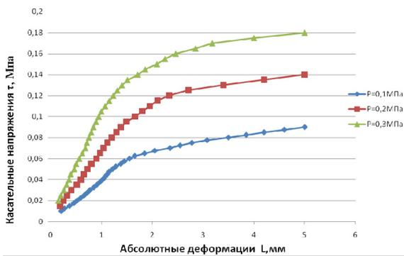
Рисунок 8 – График зависимости деформаций грунта от сдвигающих напряжений. Грунт отобран с площадки № 3
