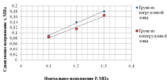
Рисунок 12 – График зависимости сдвигающих напряжений от нормальных. Грунт отобран с площадки №3
