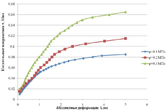
Рисунок 9 – График зависимости деформаций грунта от сдвигающих напряжений, ненагруженная зона площадки № 3
