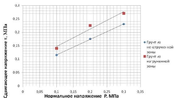
Рисунок 10 – График зависимости сдвигающих напряжений от нормальных. Грунт отобран с площадки № 1
