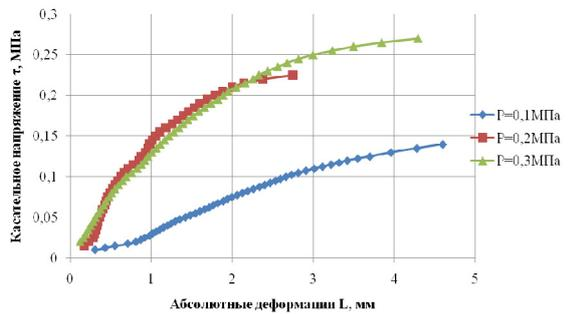
Рисунок 5 – График зависимости деформаций грунта от сдвигающих напряжений нагруженной зоны площадки № 1
