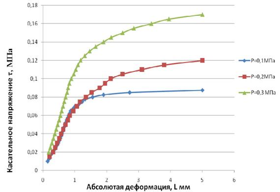
Рисунок 7 – График зависимости деформаций грунта от сдвигающих напряжений ненагруженной зоны площадки № 3
