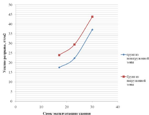
Рисунок 13 – График зависимости усилия разрыва от срока эксплуатации здания
