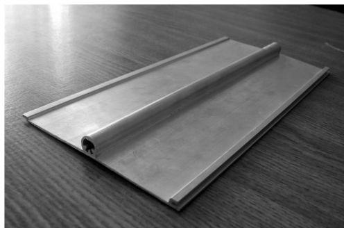
Рисунок 6 – Фрагмент конструкции труба – лист
