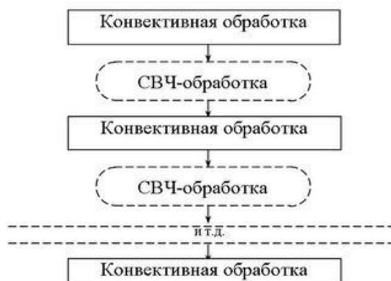
Рисунок 1 – Принципиальная схема процесса сушки зерна с использованием СВЧ-энергии
