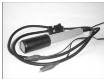
Рисунок 5 – Датчик МВС для определения межвиткового замыкания в обмотках статора [5]
