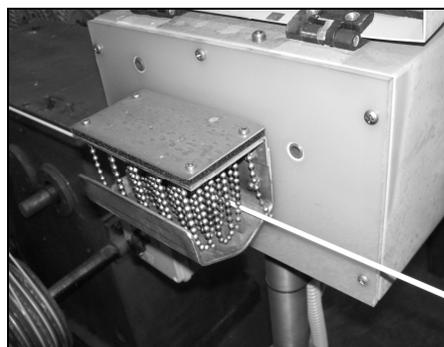
Рисунок 1 – Электродный узел электроискрового дефектоскопа и положение испытуемого кабеля в нем
