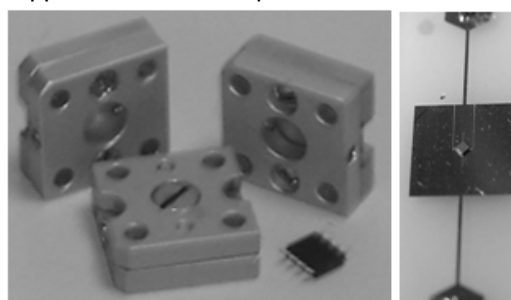
Рисунок 5 - Модули 5-мм диапазона -(1-3) («Тигель-05»), имеющих размеры 15x15x6мм, вес менее 3,5г (БШ2.000.138ТУ)
