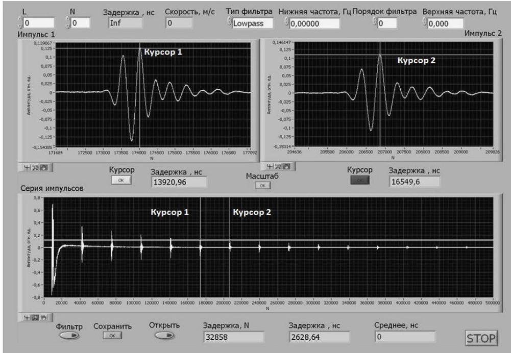
Рисунок 4 - Вид окна графического редактора для определения времени задержки между двумя эхо-импульсами (левое и правое окна сверху), отмеченными курсорами 1 и 2 в серии отраженных импульсов (нижнее окно). Пояснения в тексте
