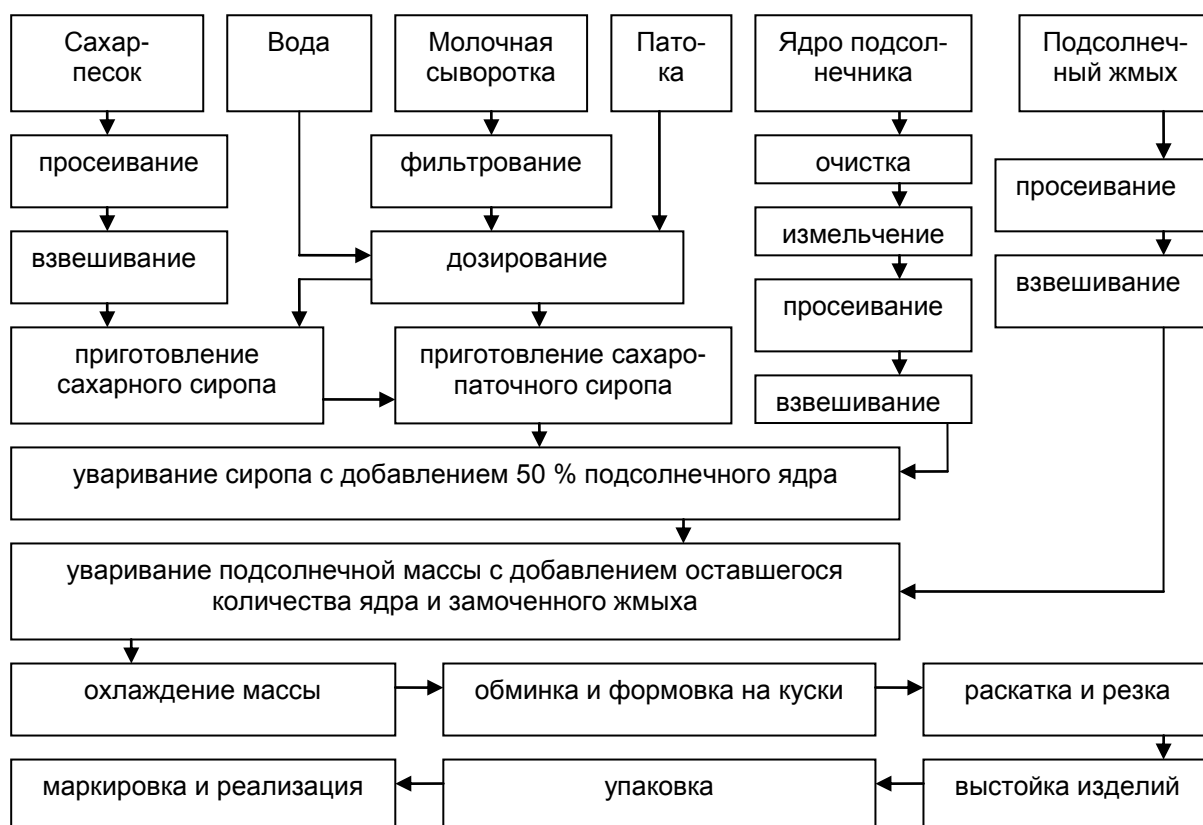
Рисунок 1 – Технологическая схема производства козинаков
