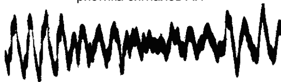
Рисунок 4 - Характерный вид осциллограммы сигналов АИ (длительность развертки 2 \cdot 10^{-4} с)
