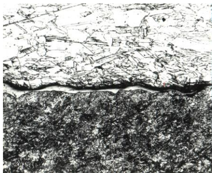
Рисунок 3 – Структура сварного соединения титан-медь, полученного сваркой взрывом при распространении процесса детонации ВВ вдоль короткой стороны листа, \times 100
