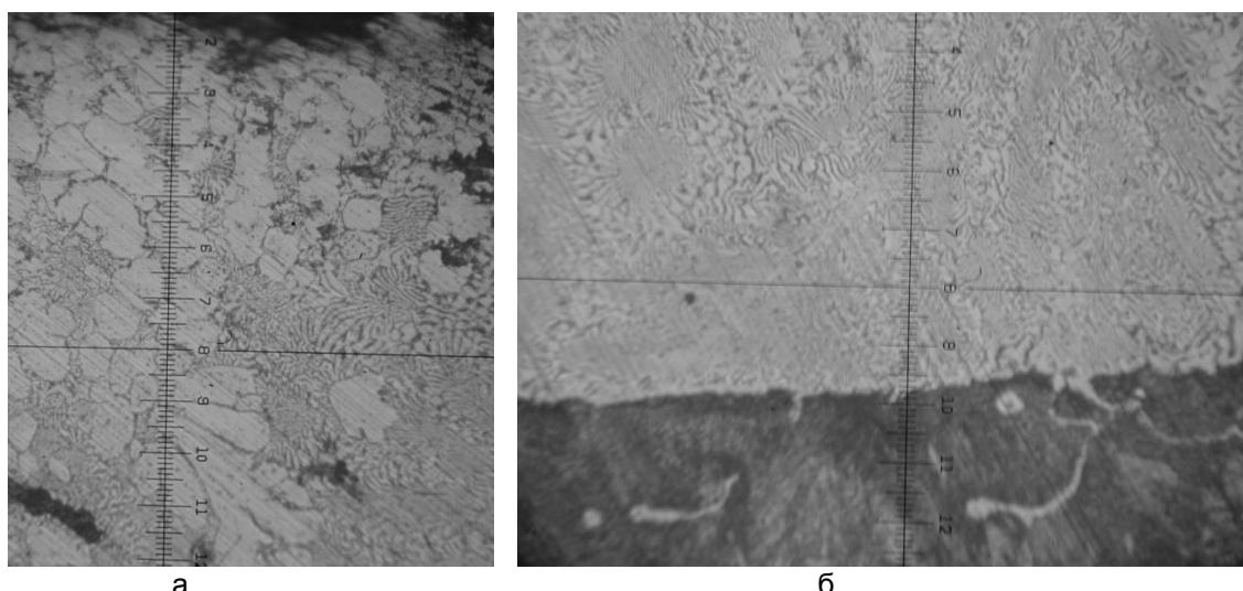
Рисунок 6 – Микроструктура диффузионного боротитированного слоя на стали 45Л, полученного при литье, а – цена деления шкалы 10 мкм, б – цена деления шкалы 2,5 мкм
