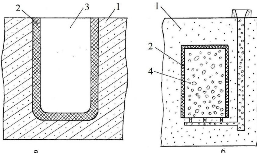
Рисунок 2 – Нанесение обмазки: а – литье в песчано-глинистые формы, б – литье по газифицируемым моделям (1 – литейная форма, 2 – насыщающая обмазка, 3 – полость формы, 4 – модель из пенополистирола)
