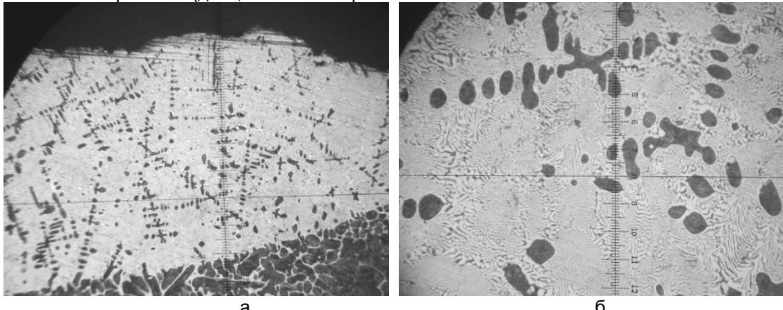
Рисунок 5 – Микроструктура диффузионного борохромированного слоя на стали 45Л, полученного при литье, а – цена деления шкалы 10 мкм, б – цена деления шкалы 2,5 мкм
