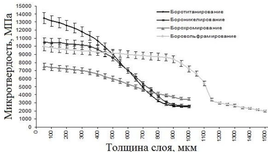
Рисунок 4 – Распределение значений микротвердости в упрочненном слое стали 45Л после упрочнения бором совместно с другими элементами (Cr, Ni, Ti и W)
