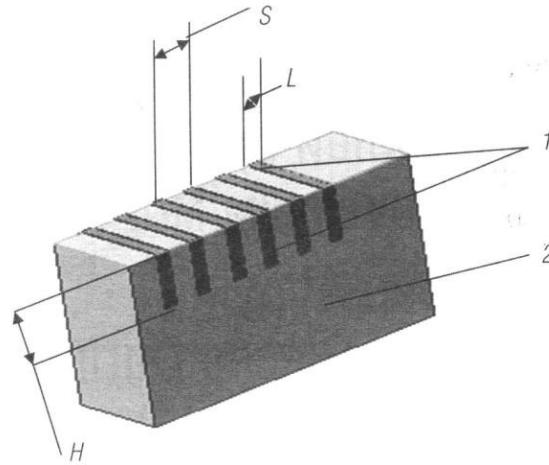
Рисунок 1 – Схема установки металлических пластин 1 в модель 2 из пенополистирола
