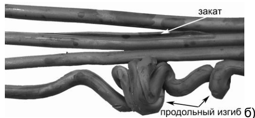
Рисунок 1 - Примеры формы полосы: а) правильная и б) неправильно разделенная во время четырехжильной прокатки ребристых прутков диаметром 12 мм [1, 8]
