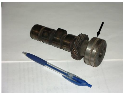
Рисунок 4 - Распределительный вал ДВС после ремонта методом электроннолучевой наплавки (стрелкой указано место износостойкой наплавки)
