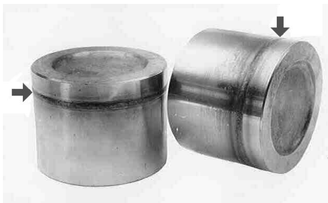
Рисунок 1 - Заготовки поршней из сплава АК21М2,5Н2,5 с упрочненными зонами под проточку кольцевых канавок (указаны стрелками)
