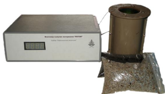
Рисунок 1 – Общий вид прибора контроля влажности сыпучих материалов «Поток»
