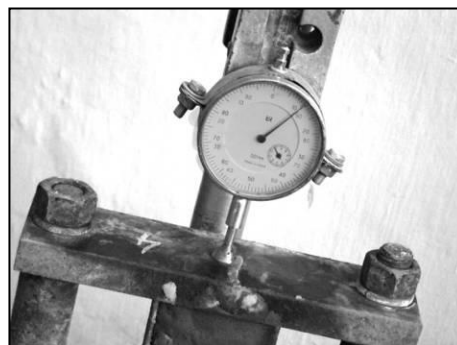
Рисунок 1 - Индикатор часового типа ИЧ-10 на репере кондуктора с образцом-призмой 50×50×200 по [1]
