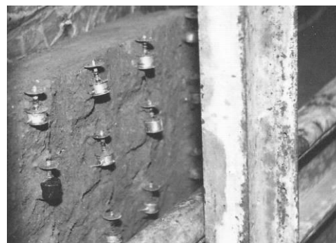
Рисунок 2 – Положение деформометров в лотке после частичного удаления грунта по окончании опыта по измерению вертикальных деформаций
