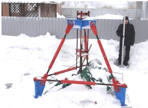
Рисунок 5 – Снятие вертикальных перемещений винтовых свай «BAU» от воздействий сил морозного пучения
