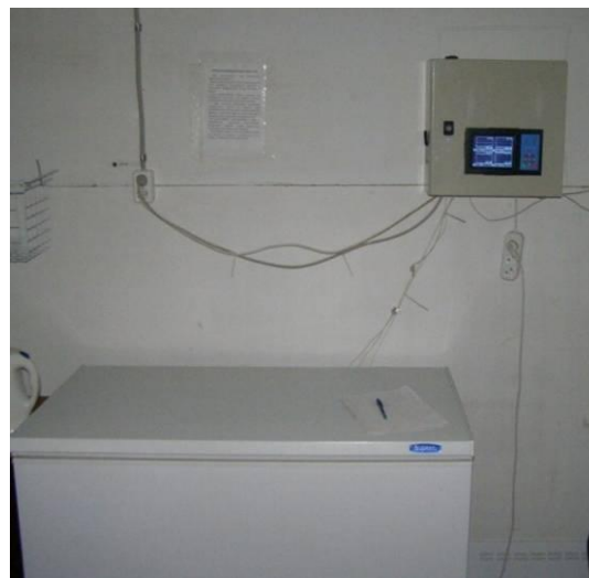
Рисунок 6 - Лабораторная установка ОСПГ-1 для проведения испытаний по ГОСТ 28622-90 «Метод лабораторного определения степени пучинистости»
