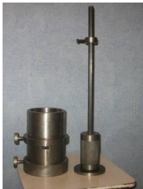
Рисунок 8 - Прибор стандартного уплотнения
