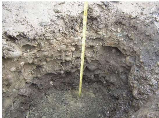
Рисунок 1 – Отбор проб грунта из дорожной насыпи для лабораторных исследований
