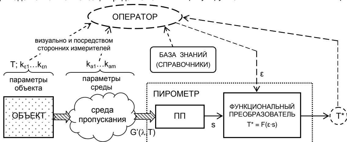
Рисунок 1 – Функциональная схема взаимодействия элементов системы «объект-пирометр-оператор» при классическом подходе: ПП – первичный преобразователь
