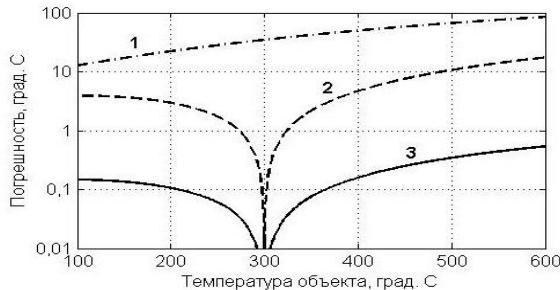
Рисунок 4 – Относительная погрешность измерения температуры пирометром частичного излучения (кривая 1 – без коррекции; кривая 2 – коррекция с использованием коэффициента  $\epsilon$ ; кривая 3 – коррекция с использованием модели)
