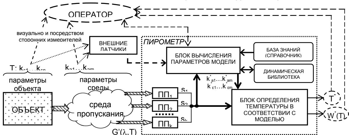
Рисунок 2 – Функциональная схема взаимодействия элементов системы «объект-пирометр-оператор» при подходе, предусматривающем учет априорных данных
