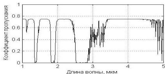
Рисунок 3 – Спектральная характеристика пропускания атмосферы для рассматриваемого примера
