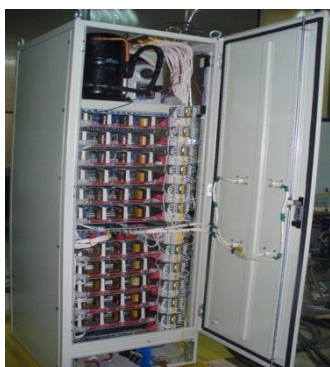
Рисунок 1 - Многоячейковый источник асимметричного тока установки микродугового оксидирования мощностью 200 кВА
