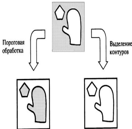
Рисунок 1 – Пороговая обработка изображения и выделение контуров на изображении
