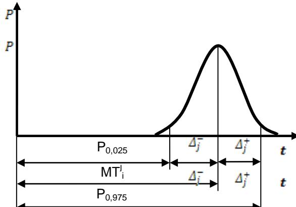
Рисунок 2- Расчет допустимого отклонения от расписания для контрольного пункта маршрута
