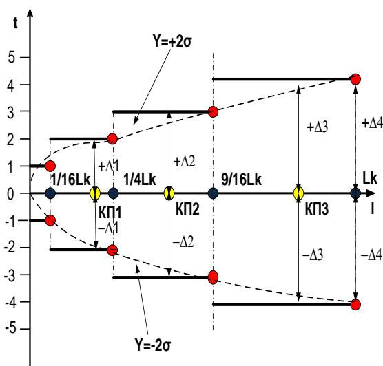
Рисунок 3 - Схема расчета допустимых отклонений от расписания на контрольных пунктах маршрута
