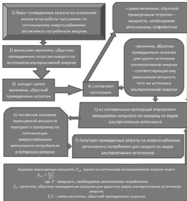
Рисунок 6 - Определение замещаемой мощности для каждого из видов альтернативных источников энергии по минимуму приведенных затрат
