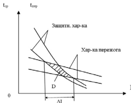
Рисунок 3 – Вариант пересечения защитной характеристики и характеристики пережога
